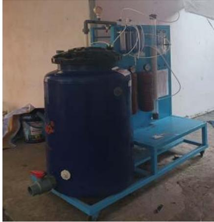
Gambar 1. Seperangkat Alat Pemurnian Biogas
