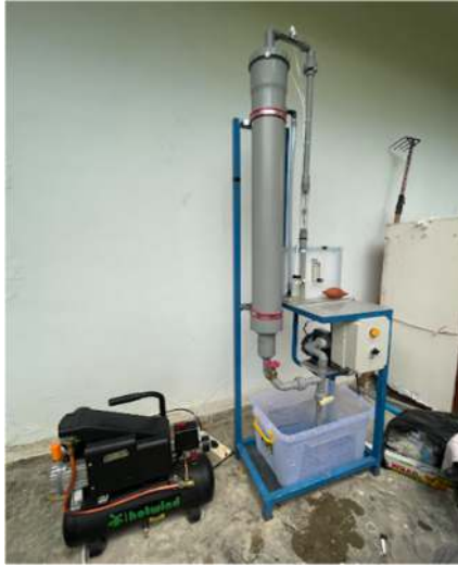
Gambar 1. Alat Kolom Gelembung Pancaran Beserta Kompresor
