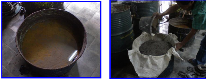
Gambar 3.1 Drum Uji yang Berisi Tanah Lunak.
