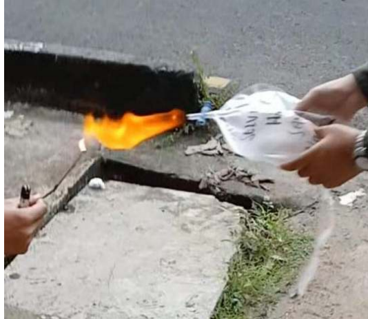
Gambar 3.4 Hasil Uji Nyala Api gas H_2
